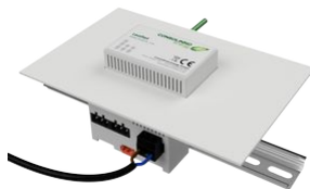
6 Einbau 4: Abdeckung prüfen und beschriften
