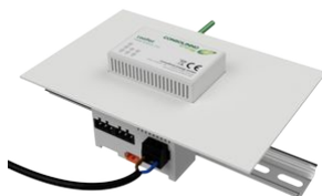
7 Einbau 4: Abdeckung prüfen und beschriften
