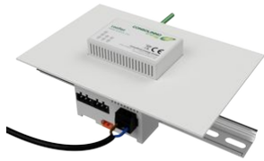
9 Einbau 4: Abdeckung prüfen und beschriften
