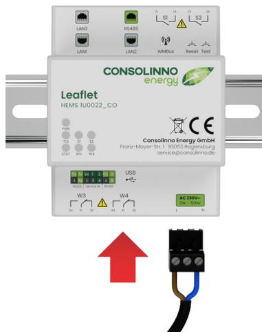
13 Spannungsversorgung verbinden
