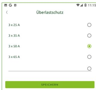
Wird eine **Wallbox** und/oder eine **Wärmepumpe** in Kombination mit dem Leaflet HEMS verwendet, wird im Überlastschutz-Menü der entsprechende Überlastschutz eingestellt.
