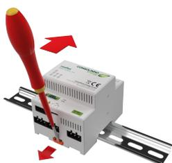
124 Demontage 4: Gerät von der Hutschiene nehmen
