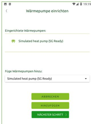
Anschließend wird die eingerichtete Wärmepumpe angezeigt. Der KI-Optimierer kann nur eine Wärmepumpe pro HEMS-System optimiert steuern. Ein Klick auf **[Nächster Schritt]** setzt die Einrichtung fort.
