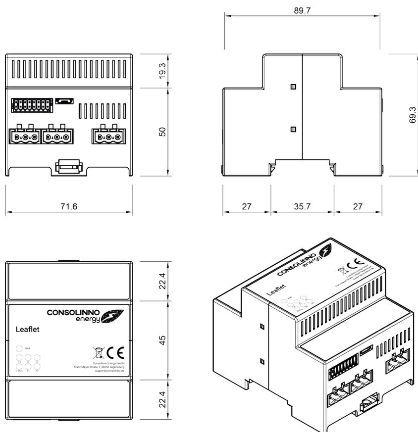
Bei allen Leaflet HEMS-Varianten werden individuell angepasste Gehäuse verwendet. Die allgemeinen Abmessungen sind bei allen Varianten auf 4 TE (Teilungseinheiten) festgelegt: 71,6 mm x 89,7 mm x 69,4 mm.
