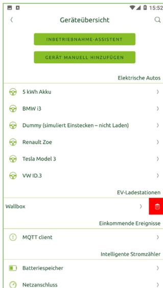
Im *Schraubenschlüsselmenü* wird (auf der Startseite oben rechts) unter *Inbetriebnahme* die *Geräteübersicht* angezeigt. Das ausgewählte Gerät wird durch links Wischen mit der rot hinterlegten Mülltonne gelöscht.
