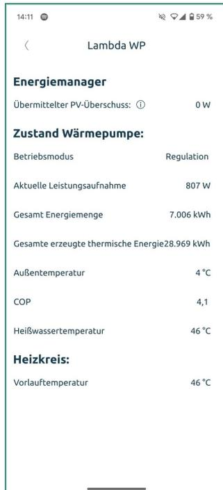
Beim Klick auf die Wärmepumpenkachel am Dashboard werden Detailwerte wie Energieverbräuche, thermische Erzeugung, COP oder auch der Vorlauf im Heizkreis angezeigt.
