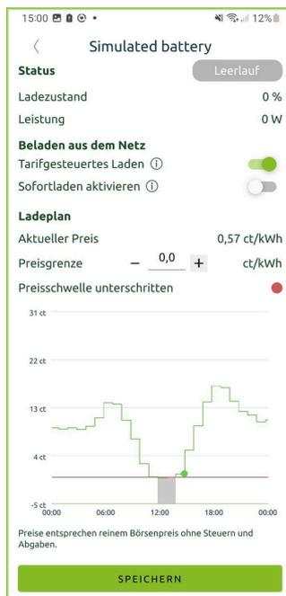
Das Sofortladen der Batterie dient dazu die Batterie sofort zu laden unabhängig vom aktuellen Börsenpreis oder der PV-Produktion. Wird der Toggle aktiviert dann wird die Batterie voll geladen. Soll der Ladevorgang vorzeitig beendet werden, kann der Toggle deaktiviert werden. Nachdem Sofortladen sind die bisherigen Einstellungen zum Tarifgesteuerten Laden wieder aktiv.
